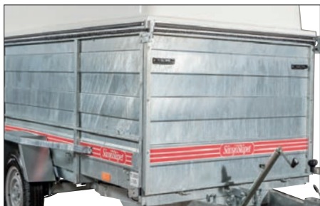
Förhöjningsläm höjd 63/79 cm Ökar lastvoly- men, dörr och ramp baktill, i galvaniserat stål
