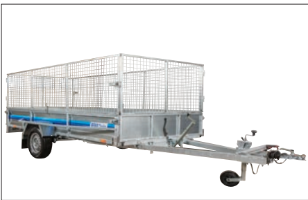
Nätlämsats komplett höjd 78 cm Ökar lastvolymen, både fram- och bakgrund är vikbara med gångjärn, för enklare hantering
