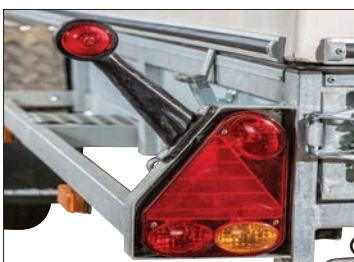
Breddmarkeringslykter och belysning skyddad i box
