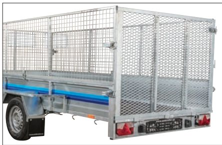
Nätlämsats komplett höjd 78 cm med integrerad uppkörningsramp höjd 112 cm Ökar lastvolymen, i kraftig stäckmetall, underlättar på- och avlastning
