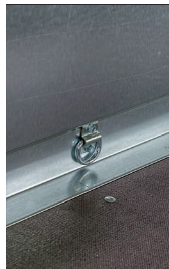
Surringsöglor i lämsidan
