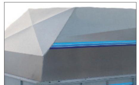
Kåpa i aluminium Skyddar lasten mot regn och smuts och ökar trailerns lastvolym, fästena och två gasdämpare i framkant
