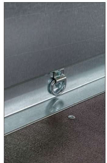
Surringsöglor i lämsidan
