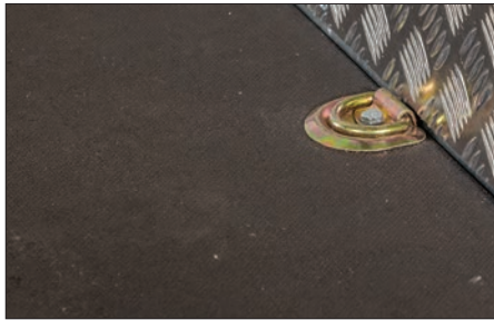
Surringsögla flakmonterad Profil som monteras i flakskivan, säkrar lasten under färd i kombination med spännband
